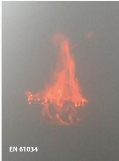
Dégagement de fumée lors du test EN 61034 : Cet essai de résistance au feu a été réalisé avec un câble qui répond aux exigences.
