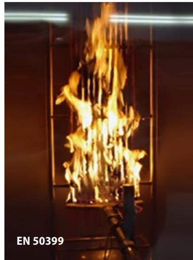
La majeure partie des paramètres exigés dans l'ordonnance sur les produits de construction pour les câbles sont déterminés par le test selon EN 50399.
