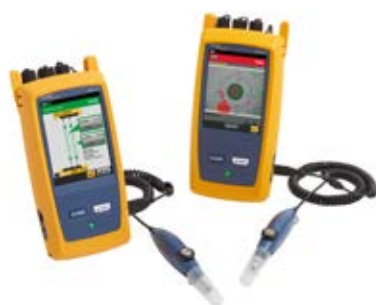
Dämpfungsmessgeräte und Faserinspektion
