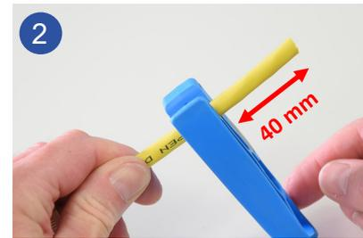
Setzen Sie den Kabelmantel am Datenkabel mit einem geeigneten Abmantelwerkzeug auf ca. 40 mm ab.
