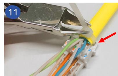
Befestigen Sie das Kabel mit einem Kabelbinder und schneiden Sie das überstehende Ende ab.
